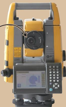
レーザー光を出し、跳ね返ってきた速さで距離・角度を測ることが出来る機械。あらゆる測量現場で最も多く使用されています。
